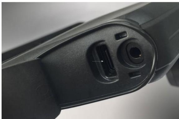
El puerto USB-C sirve para hacer cargas rápidas y suministrar energía. Se encuentra abajo de la lengüeta posterior sobre el costado del brazo de extensión del dispositivo.
