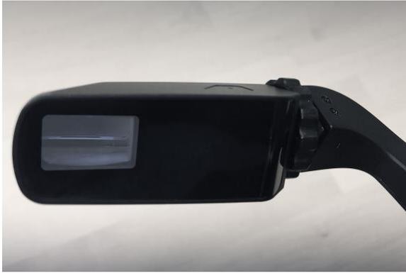
El soporte de pantalla se puede girar y ajustar para que el usuario pueda ver la pantalla con claridad. La pantalla en sí es LCD de 24 bits de 854 x 480p con un campo visual de 20 grados y una profundidad focal de 1 metro, lo cual significa que parece una tableta de 7 pulgadas a la longitud del brazo.
