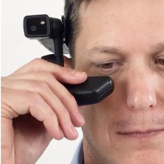
Asegúrese de que el soporte de pantalla esté girado de manera tal que las cuatro esquinas de la pantalla se puedan ver claramente. Con el HMT encendido y el soporte de pantalla en la posición correcta, podrá ver toda la pantalla de inicio.
