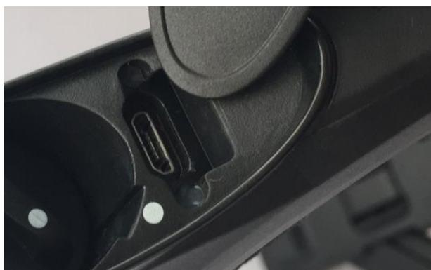
Para todas las transferencias de datos, se debe utilizar el puerto micro-USB, el cual se encuentra junto al compartimiento de la batería, debajo de la lengüeta del lado opuesto del brazo de extensión.
