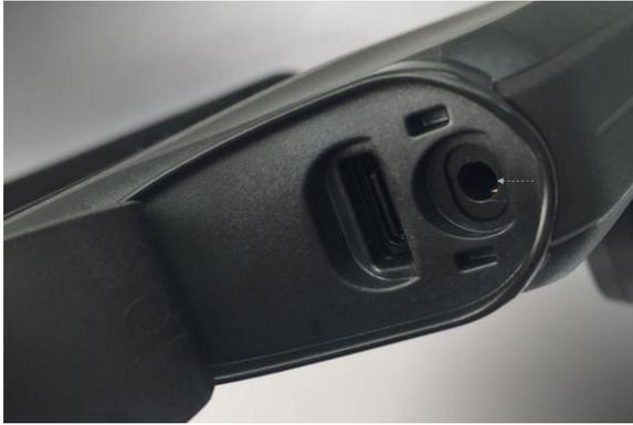
Los audífonos se pueden conectar al HMT-1 en este enchufe. Recomendamos utilizar tapones RealWear de reducción de ruido de 33 dB con el HMT-1. El enchufe se encuentra junto al puerto USB-C.
