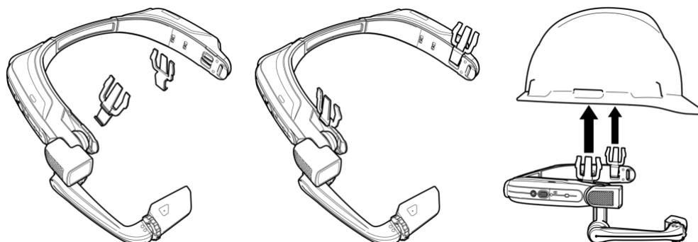
1. Enganche las pinzas del casco en la banda del HMT.
