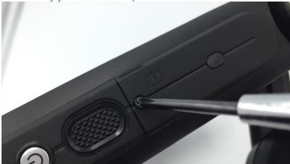
Paso 2: Abra la puerta de la ranura de la tarjeta MicroSD y manténgala abierta con el dedo pulgar.
