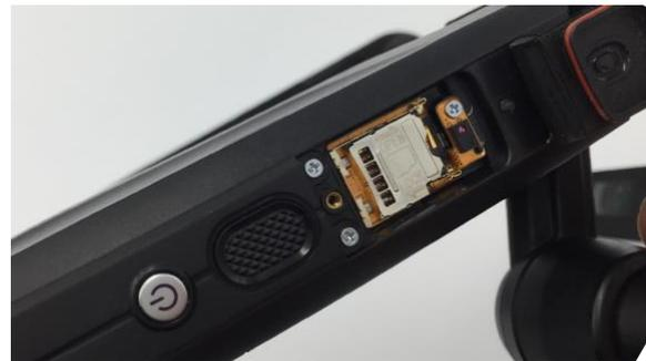
Paso 3: Desbloquee el compartimiento de metal y gírelo hacia afuera para abrirlo.
