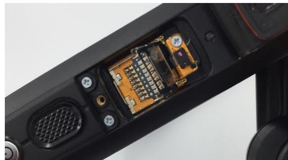
Paso 4: Introduzca la tarjeta MicroSD en el compartimiento como se muestra abajo.
