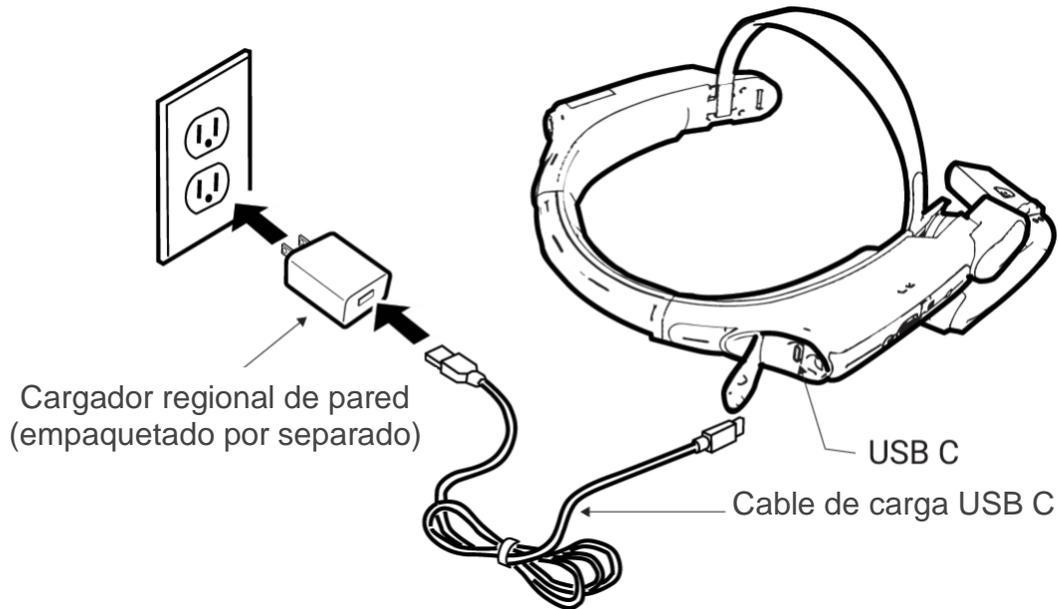
2. Conecte el cable de carga al cargador de pared.
