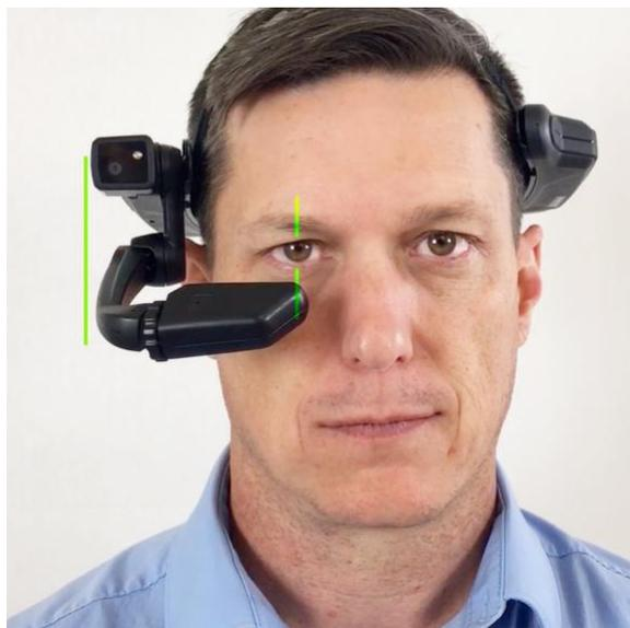
Enseguida, sostenga el brazo de extensión con una mano, con la otra sostenga la parte posterior del HMT y empuje el soporte de pantalla hacia adentro de manera que quede cerca del ojo, enfrente y ligeramente abajo del mismo.
