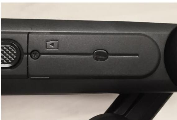
El compartimiento de la tarjeta MicroSD se abre con un destornillador de estrella 001. Se puede introducir una tarjeta MicroSD con formato FAT32 y de una capacidad máxima de 256 GB para tener un almacenamiento portátil.
