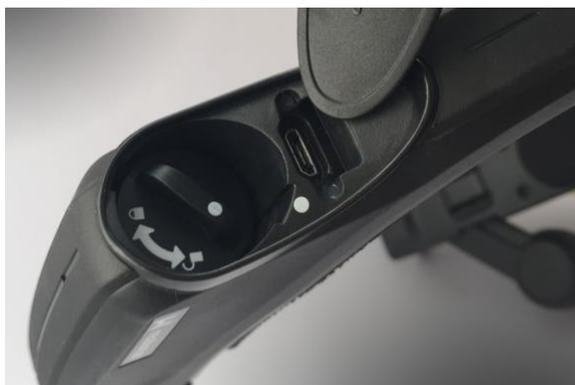
La tapa de la batería se puede quitar con un pequeño giro a la izquierda seguido de un jalón. Después de quitarla, incline el dispositivo para sacar la batería. Para volverla a poner, coloque una batería recargada, presione para fijar la tapa de esta y gire ligeramente hacia la derecha para cerrarla. Asegure la lengüeta.
