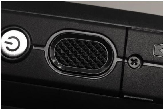
Este es el botón grande y con textura que está junto al de encendido y tiene varias funciones. Un solo toque sirve como mecanismo de seguridad para regresar a la pantalla de inicio. Con tres toques rápidos consecutivos se alterna la selección de micrófonos que hay entre la configuración frontal y posterior.
